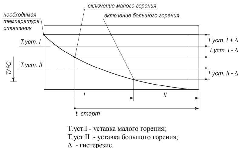
Рисунок 21. Динамика работы котла при охлаждении
