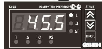
Рисунок 22. Изменение уставок малого и большого горения котла
